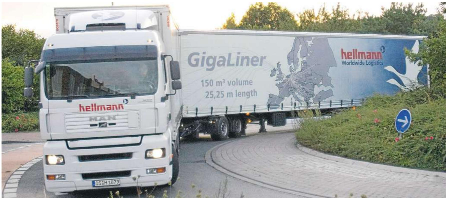
Über 25 Meter lang sind die Riesenlaster, die Verkehrsminister Ramsauer im Feldversuch zugelassen hat. Ein normaler Brummi besitzt eine Länge von etwa 16,5 Metern.
